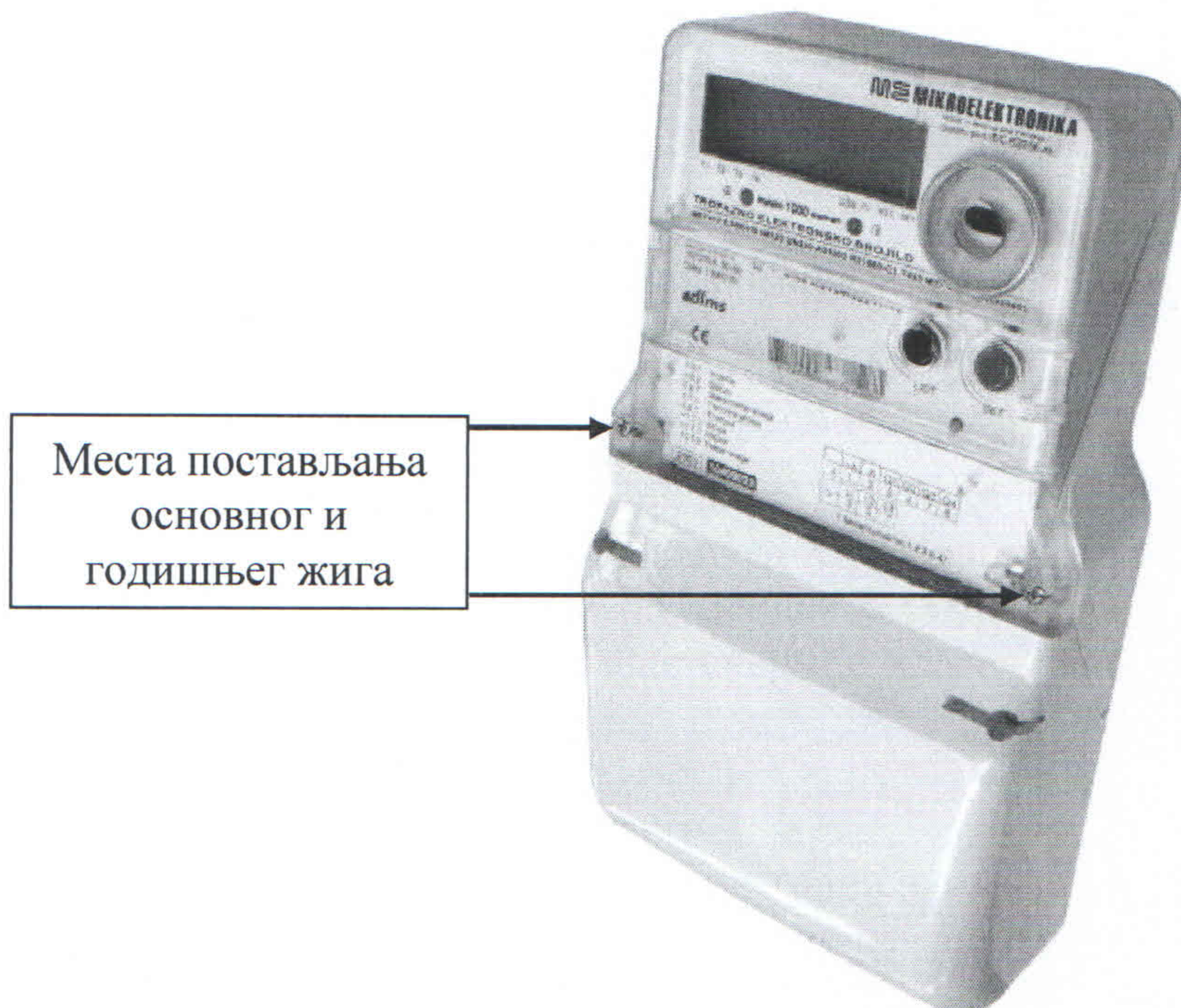
Слика 5. Места на бројилу за постављање оловне пломбе са основним и годишњим жиговима
