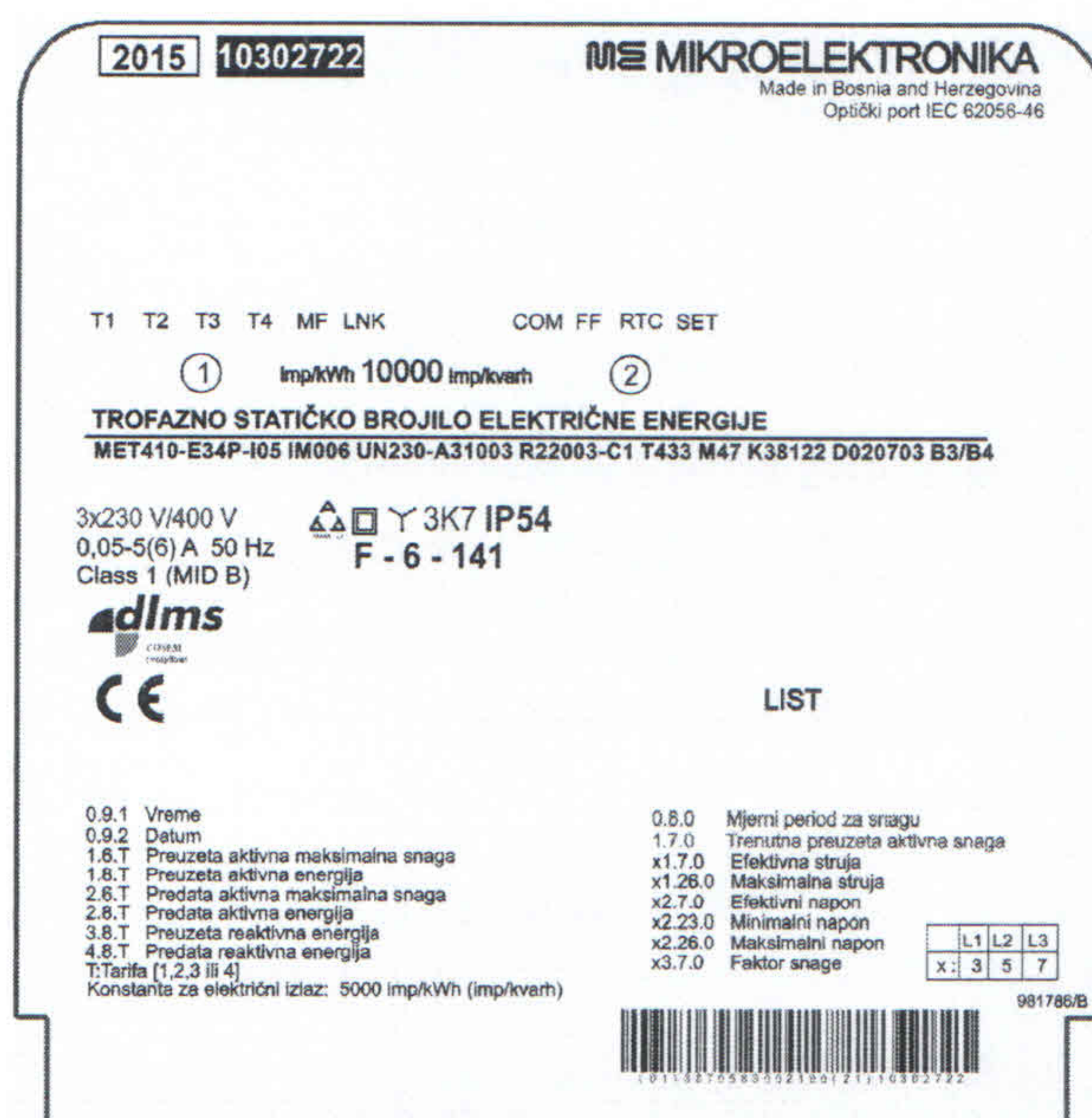
Слика 4. Изглед натписне плочице бројила
