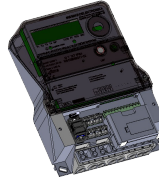
Slika 7. Način postavljanja komunikacionog modema na brojilo
